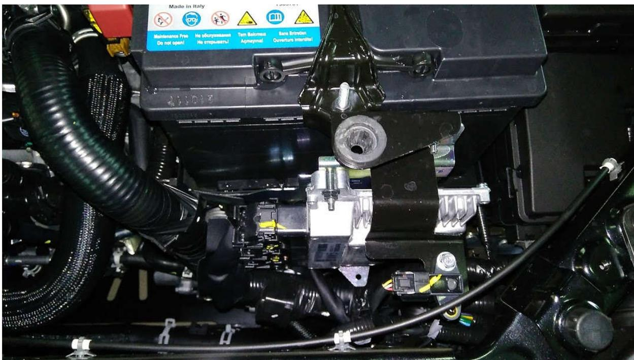
4. Установить защиту на блок управления двигателем.
